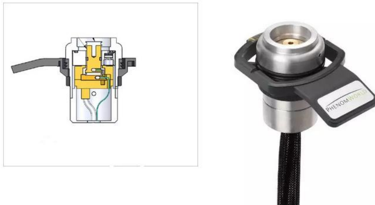
图 2 飞纳电镜温控样品杯的内部构造示意图
